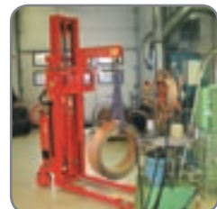
Coils werden zu einer Stanzmaschine transportiert.
