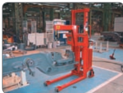
Der Kranarm im Einsatz bei der Herstellung von Zugkomponenten.
