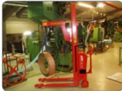
Der Kranarm beim Einsatz in der Komponentenherstellung.
